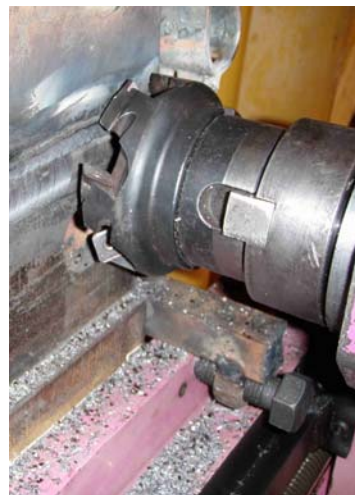
Fresado de la superficie Fuente: P7270545.JPG
